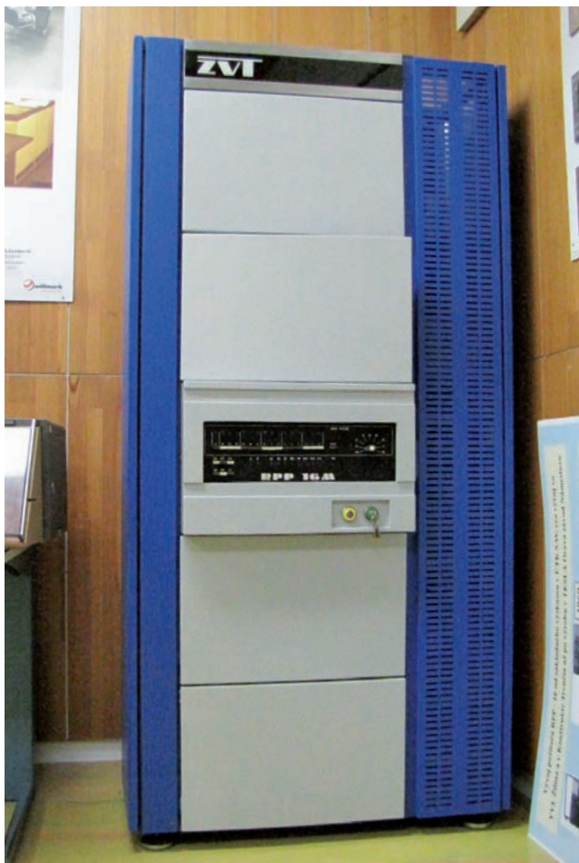
Inovované stojanové vyhotovenie počítačov RPP 16 S aj M bolo nielen kompaktnějšíe, lacnejšie, spoľahlivejšie, ale aj ergonomickéjšie. Na obr. je dochovaná základná konfigurácia stojanového vyhotovenia RPP 16 M, ktorá sa nachádza v SV DVT SAV.
