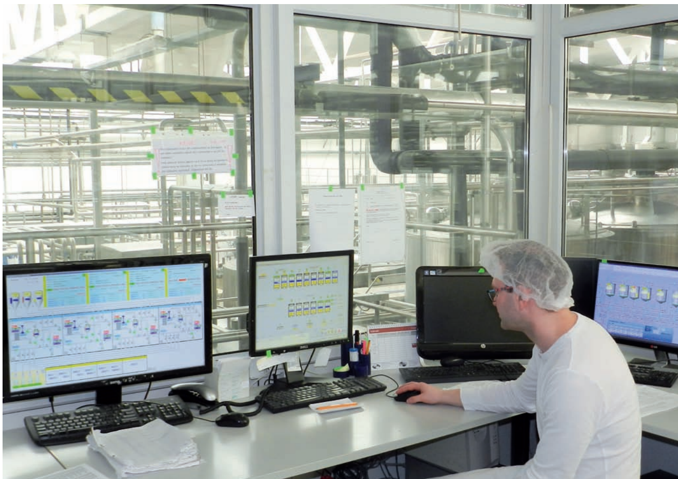
Operátor má prostredníctvom systému SCADA v reálnom čase podrobný prehľad o jednotlivých častiach výrobných technológií v jednotlivých strediskách.
