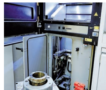
Zákazková verzia EOSINT M 280: Systém bol individuálne prispôsobený požiadavkám spoločnosti Siemens a pomáha zjednodušiť a urýchliť opravy horákov pre priemyselné plynové turbíny (zdroj: Siemens).
