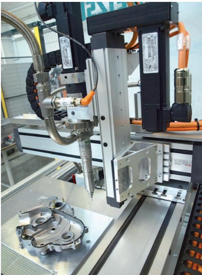
Kartézské roboty sú rovnako spoľahlivé ako roboty SCARA či kĺbové roboty. Sú konfigurovateľné, takže výrobné spoločnosti nemusia pri zmene pracoviska nakupovať nové zariadenia.
