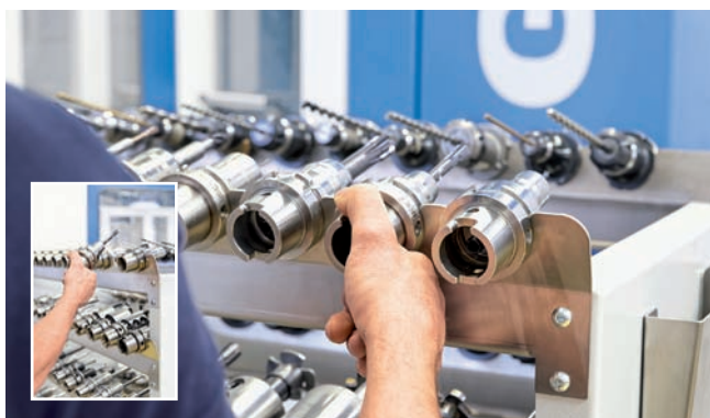
Pretože sú kuželové rozhrania upínačov nástrojov voľne prístupné, riziko porezania je prakticky eliminované.
