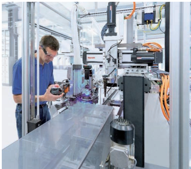
Kartézsky robot má riadenie, ktoré umožňuje operátorom bezpečne vstúpiť do priestoru stroja, aby naučil robot správnym pohybom, a to len uchopením jeho koncového člena a jeho presúvaním z bodu do bodu. Tým sa skraca čas, ktorý musia operátori venovať naučeniu robota správnym pohybom, a znižuje sa potreba technikov na vykonávanie zmien na strojoch, ktoré sú v prevádzke.
