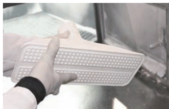
Spodná časť chápadla so vzorom švajčiarskeho syra v tvare kanálikov, ktoré vedú k vákuovému otvoru v hornej časti obrobku. Bežným obrábaním by takéto otvory nebolo možné vyrobiť, ale pomocou aditívnej výroby to bolo ľahké (zdroj: Anubis 3D)
