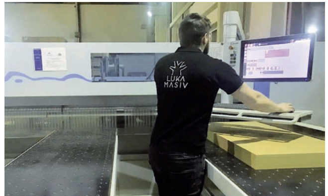
Moderná nárezová automatizovaná píla využíva pre delenie MDF dosák nárezové plány, ktoré si dokáže podľa potreby obsluha vybrať z menu na operátorskom paneli.
