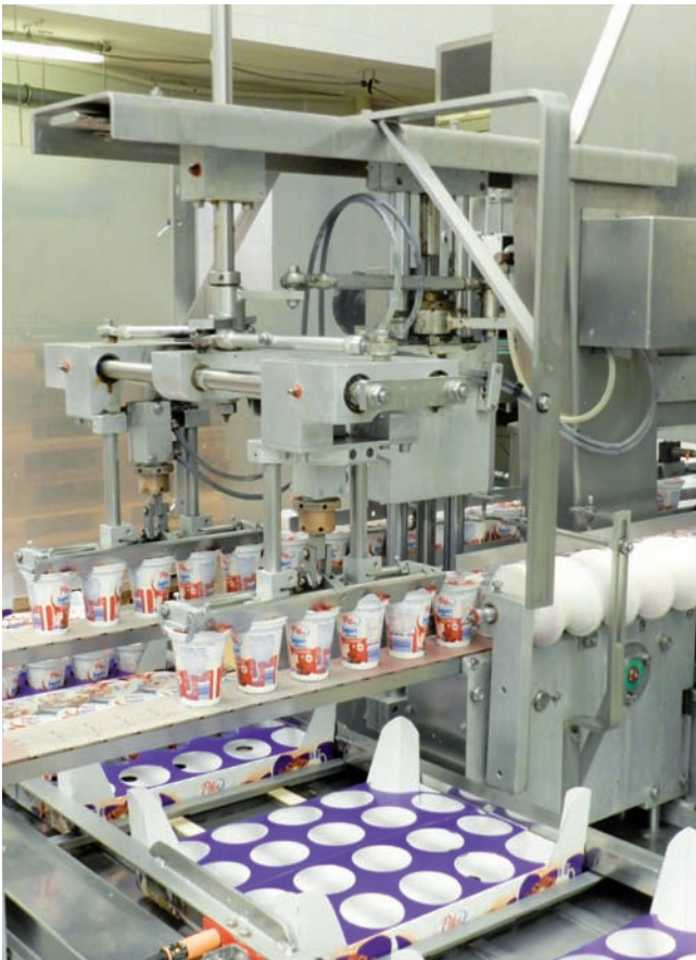
Závitkové zariadenie rozraďuje jogurty do pozícií s presne definovanými rozstupmi. Následne manipulátor uchopí tégliky a umiestni ich do kartónového obalu.
