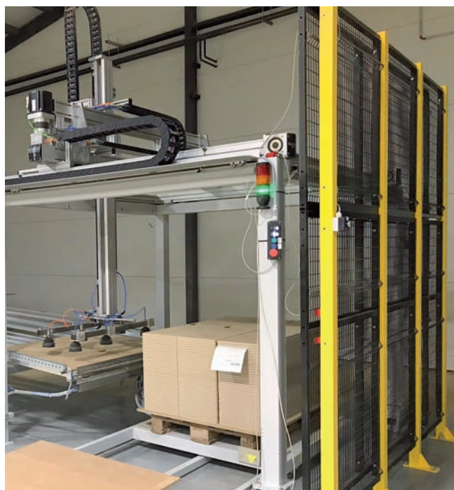
Výstupná časť brúsky s manipulátorom počas montáže bezpečnostného oplotenia. Spolu s manipulátorom na vstupe sa výrazne zvýšila plynulosť práce celého pracoviska brúsenia.
