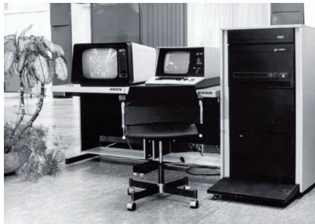
Na základe počítača SM 3-20 vznikla aj interaktívna grafická stanica GS 1, ktorá obsahovala okrem počítača SM 3-20 aj abecedné číslicový videoterminál CM 7202 a interaktívny vektorový grafický displej CM 7405.
