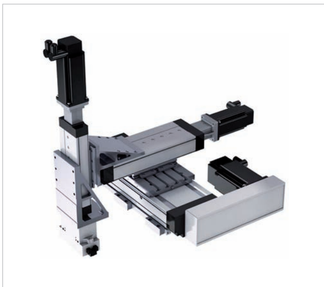
Koncoví používatelia dokážu veľmi jednoducho meniť časti kartézskych robotov, ako sú montážne konzoly, akčné členy, motory a riadenie s cieľom naplniť meniace sa potreby aplikácií. Napríklad aby sa podarilo splniť nové požiadavky aplikácie, možno kartézsky robot namontovaný v nadzemnom priestore premiestniť a namontovať na stenu.
