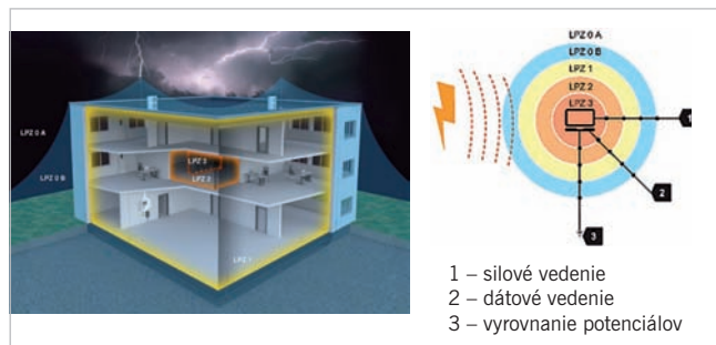
Obr. 1 Princíp ochrany podľa koncepcie zón ochrany pred bleskom
